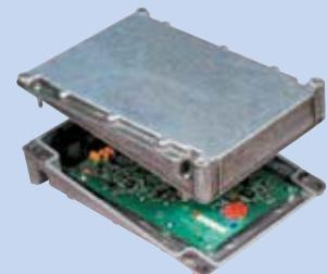
con un cofre sellado, dejando a las tablillas de circuito críticas expuestas a los elementos duros que pueden afectar lo electrónico de la máquina, y por lo tanto, su operación.
